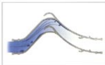
Funktionsprincip for en lamel udskiller
