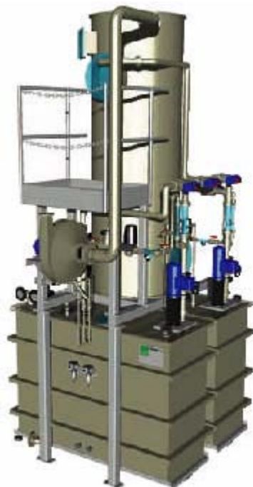
Modstrøms fyldlegeme skrubber/luftvasker type BVS 1000-S med alle nødvendige systemkomponenter
